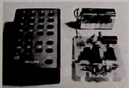
Bild 2. Infrarot-Fernbedienung für Philips-Farbfemsehgeräte. Die Schaltung wird von einer 9-V-Batterie gespeist
